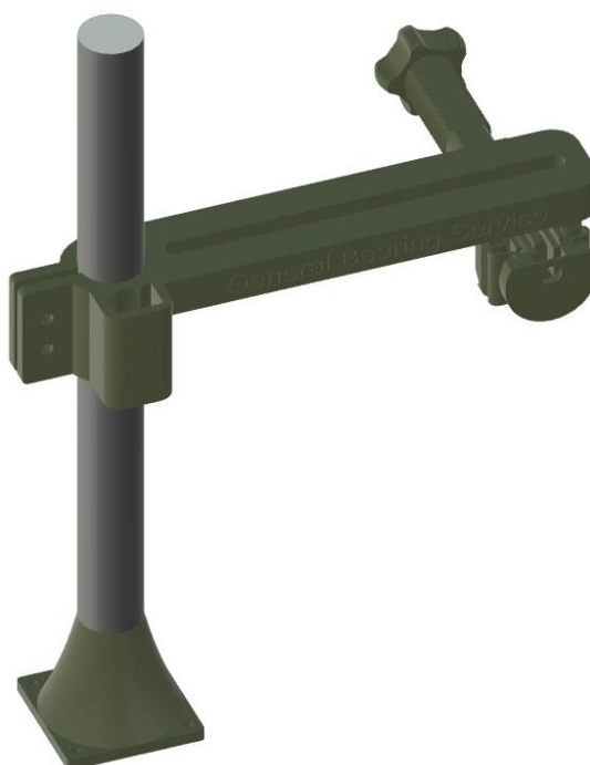
Figure 41 Modèle 3D de la tige du support à caméra assemblée avec ses accessoires
