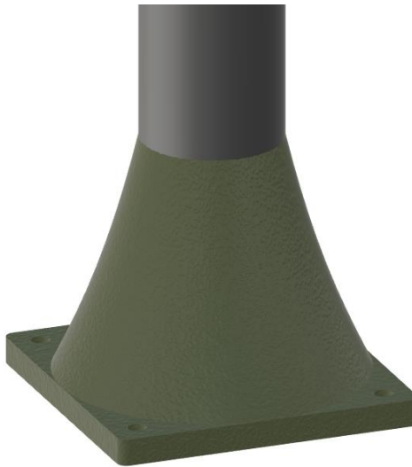
Figure 39 Modèle 3D du support de tige du support à caméra
